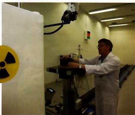
Op de kalibratieopstelling plaatst Marc van Dienen een stralingsmonitor voor radioactieve straling.
